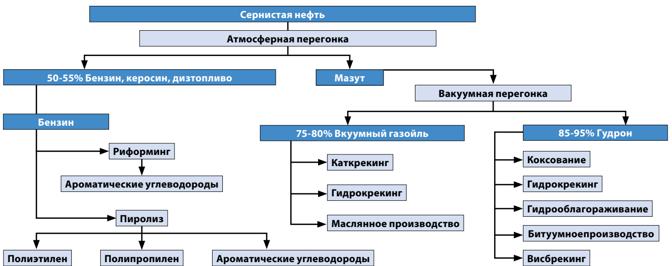
Рисунок 6. Глубина переработки нефти в зависимости от наличия тех или иных процессов 1
