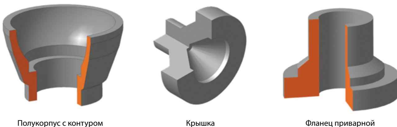
Рис 1. Полукопрус с контуром, крышка, фланец приварной, толстостенный патрубок (обечайка), шар (пробка)
