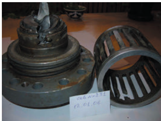
Рис. 1 Общий вид регулирующего устройства и его отказавшие функциональные детали
