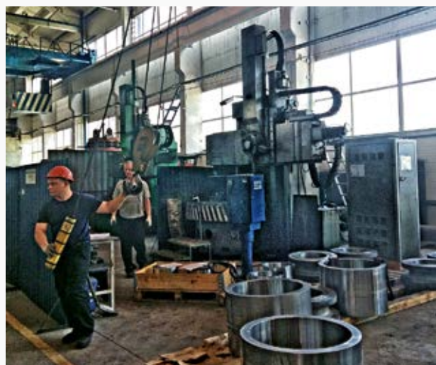
Процесс изготовления трубопроводной арматуры на заводе МКТ-АСДМ выстроен очень оптимально – размещение всех технологических участков здесь соответствует самой технологической цепочке
