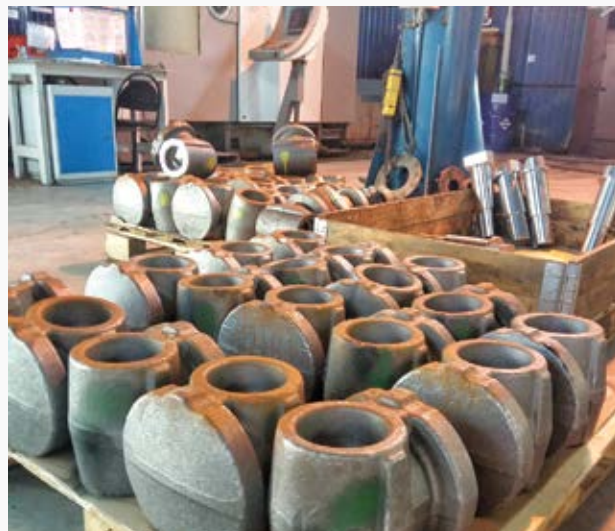
Фирма МКТ-АСДМ изготавливает штучные изделия – шаровые краны и шиберные задвижки на высокие давления, которые применяются на объектах по добыче углеводородов
