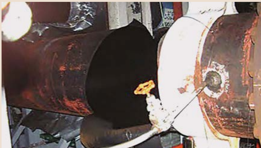
Рис. 1. Коррозионно-эрозионное повреждение на 4 блоке станции Михам в 2004 г., последствиями которого стали пять смертельных случаев и несколько пострадавших
