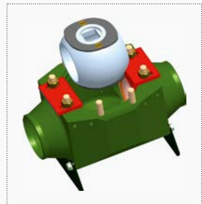
Рис. 9. Извлечение шаровой пробки из корпуса крана
