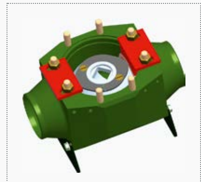
Рис. 8. Фиксация седел скобами в разведенном состоянии
