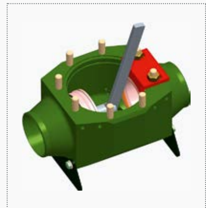
Рис. 10. Установка седел в корпус при сборке крана
