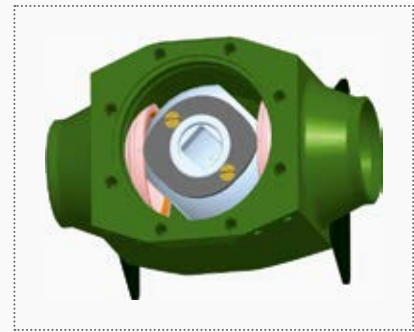
Рис. 7. Перемещение седел кулачками при повороте шаровой пробки на угол 135^\circ
