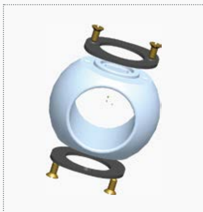
Рис. 6. Установка двух кулачков на шаровую пробку
