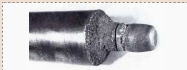
Рис. 5. Плунжер, сильно поврежденный кавитацией
