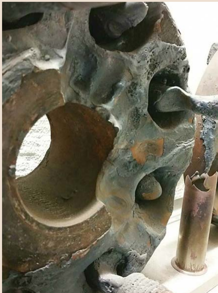
Фланец, поврежденный вследствие возгорания в среде кислорода
