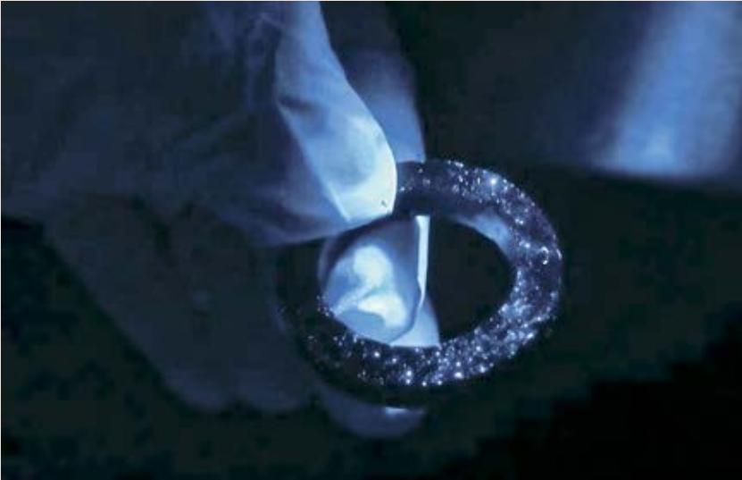
Набивочное сальниковое кольцо под УФ-излучением, при котором хорошо видны механические примеси – потенциальный источник воспламенения
