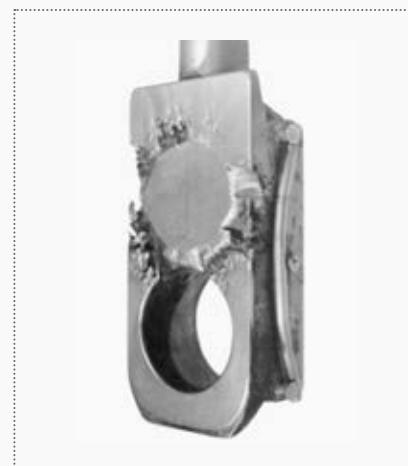
Рис. 4. Внешний вид поверхностных разрушений отказавшей детали запорного устройства
