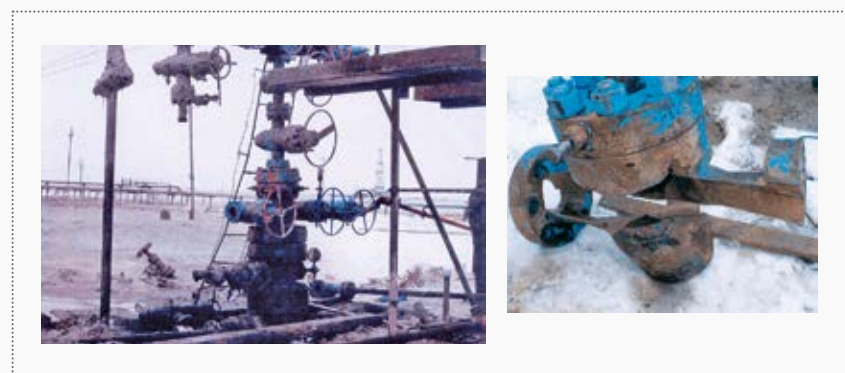
Рис. 2. Фонтанная арматура АО «РОСПАН ИНТЕРНЭШНЛ» и её задвижка после аварии (Россия)
