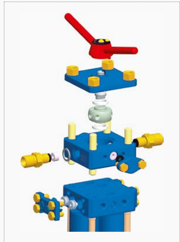
Рис. 9. Модульная конструкция насоса «Тандем»
