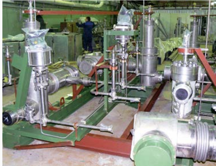
Рис. 6. Арматурные блоки криогенных клапанов
