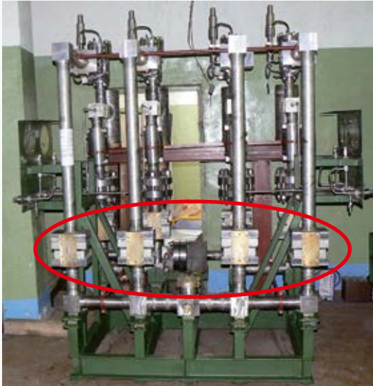
Рис. 5. Арматурные блоки с сильфонными угловыми компенсаторами из клапанов для проекта НИИМаш
