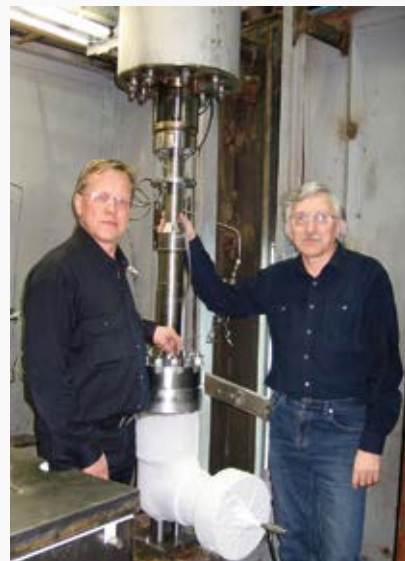
Рис. 4. Криогенный клапан с пневмоприводом при испытаниях азотом
