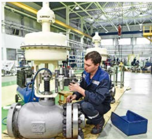
Настройка клапана осесимметричной конструкции
