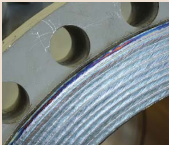
Операция, выполненная с помощью дуговой сварки под флюсом, – для неё характерно высокое качество нанесения покрытия и эффективность процесса
