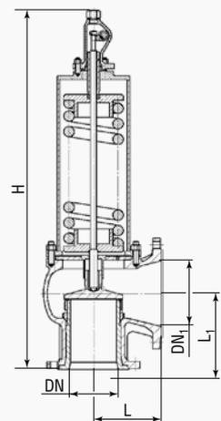
**Клапан предохранительный пружинный тип КПП6****PN 16****Среда:**
