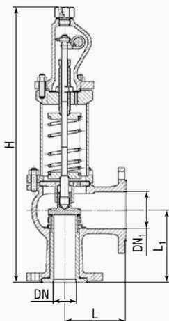
**Клапан предохранительный пружинный тип КПП6****PN 16****Среда:**
