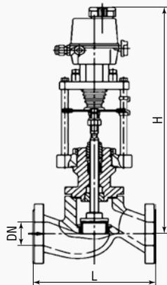
**Клапан запорный с электрическим исполнительным механизмом (ЗИМ)**
