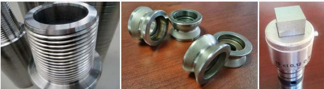
**Рис. 4.** Различные детали с минеральным покрытием
