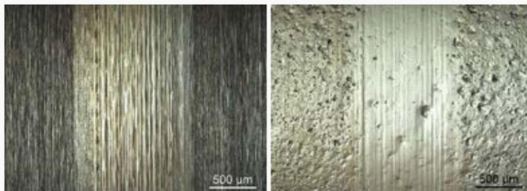
**Рис. 3.** Выполненный с помощью оптического микроскопа снимок следов износа после скольжения-качения (слева – поверхность образца из стали ШХ15 без минерального покрытия; справа – цилиндрический образец из стали ШХ15 с минеральным покрытием;  $T = 120$  °С,  $P = 1,5$  ГПа, 10 миллионов циклов, скольжение-качение)
