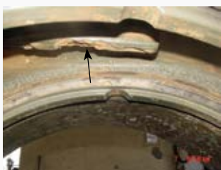
Коррозия/повреждения второй направляющей диска
