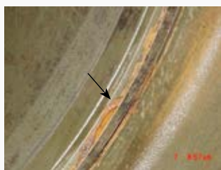
Коррозия под уплотнительным кольцом седла
