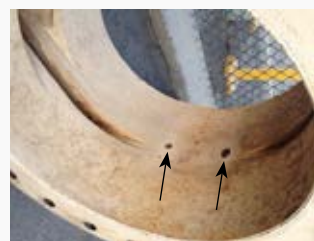
Повреждения покрытия в области седла
