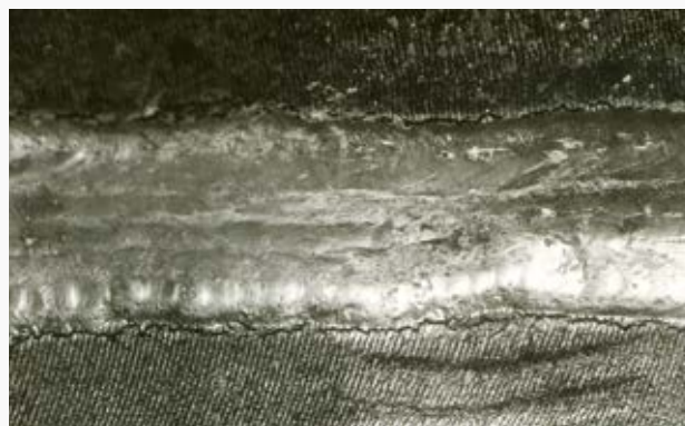
Рис. 1. Трещины по границе сплавления бронзы с металлом наплавки монель-металлом МНЖМц28-2,5-1,5
